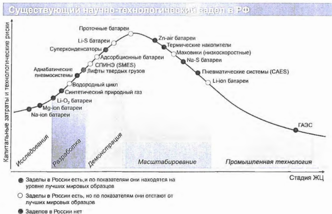
Рис. 36. Научно-технический задел в Российской Федерации по разработке и внедрению различных типов накопителей
